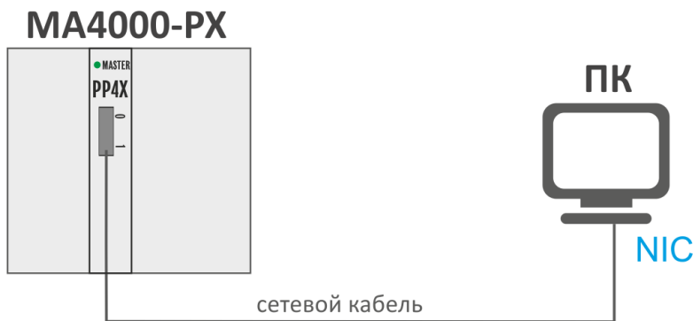
Рисунок 17 — Подключение узла доступа к компьютеру сетевым кабелем
