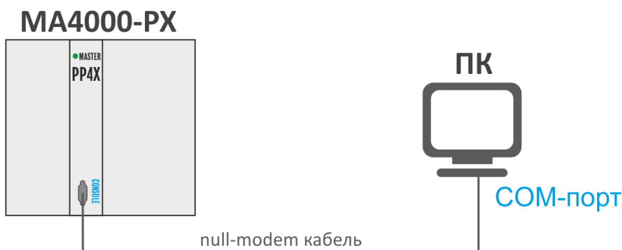
Рисунок 16 – Подключение узла доступа к компьютеру через COM-порт
