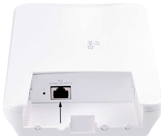
Рисунок 13 – Подключение Ethernet-кабеля к PoE-порту
