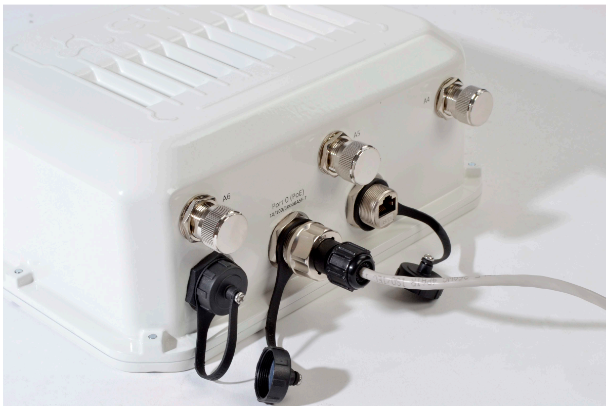
Рисунок 13 – Вид подключенного кабеля к сетевому интерфейсу устройства
