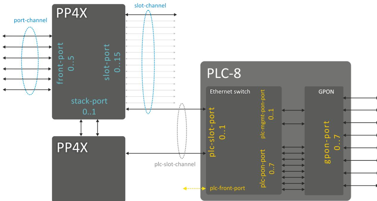
Рисунок 2 – Система имен интерфейсов узла доступа
