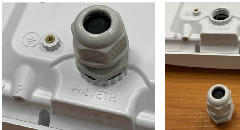
Рисунок 15 – Снятие кабельного ввода
