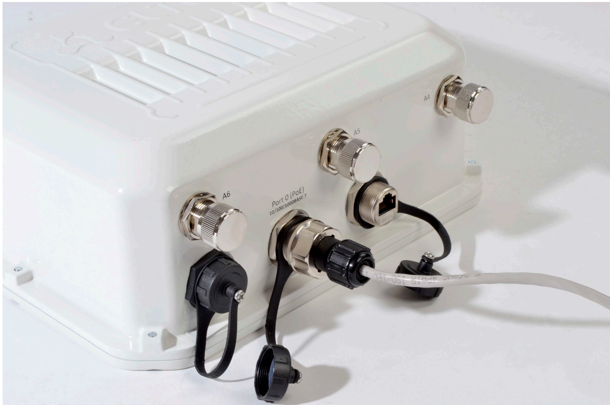
Рисунок 16 – Вид подключенного кабеля к сетевому интерфейсу устройства
